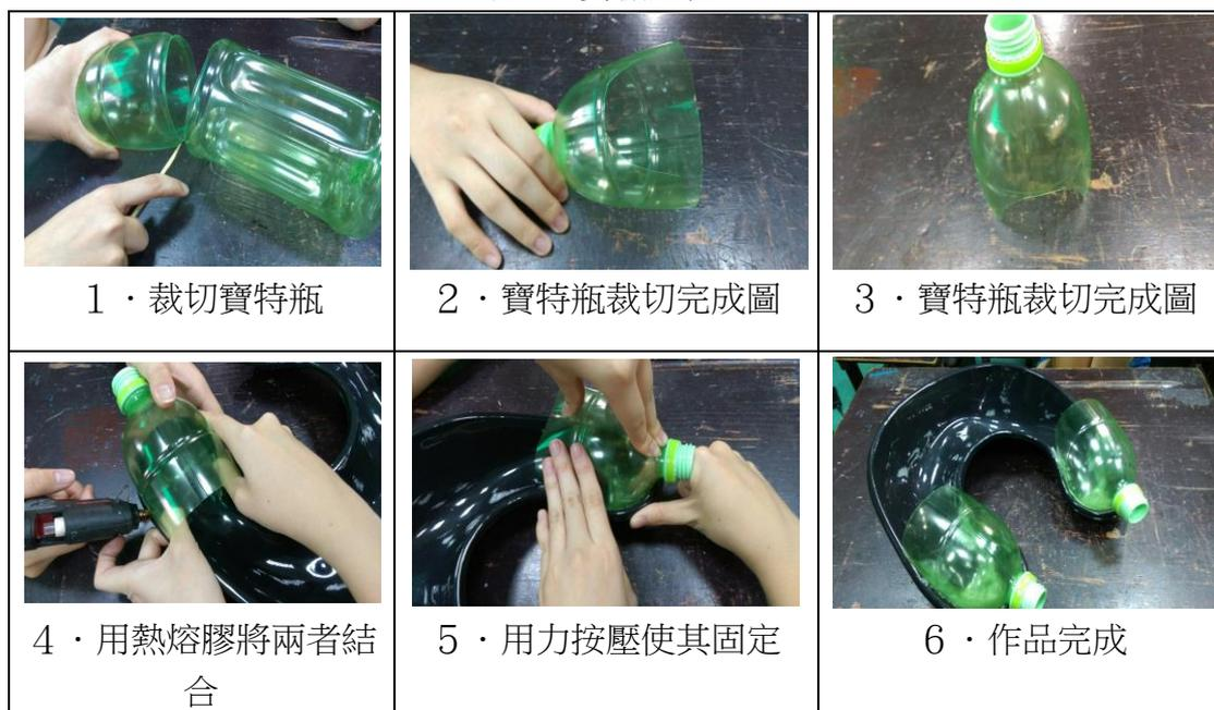
(三) 實驗三：綜合方案一、方案二的實驗過程，先將寶特瓶頂部黏U型盆上方，再將寶特瓶底部黏U型盆下方。
